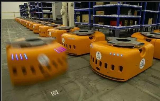
AGV货架搬运机器人
